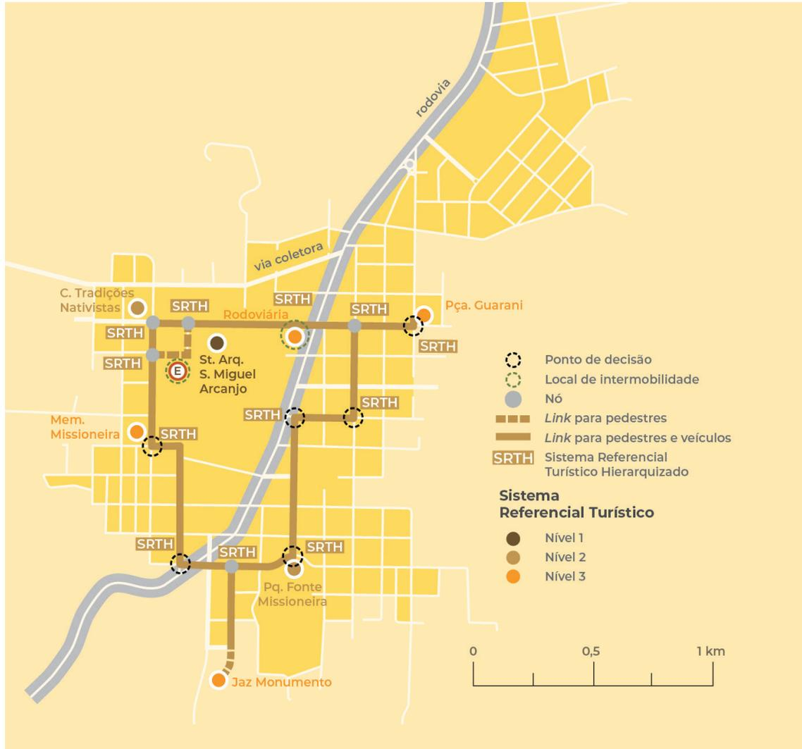
O desenvolvimento do plano funcional para RTP consiste na marcação, no esquema geral unifilar, do Sistema Referencial Turístico e de todos os pontos de decisão e nós. Na estruturação da sinalização orientativa para pedestres, deve-se selecionar as informações relativas a topônimos a serem utilizadas nas placas, respeitando o limite máximo de até seis mensagens por placa. Essa seleção obedece à seguinte regra de abrangência:
