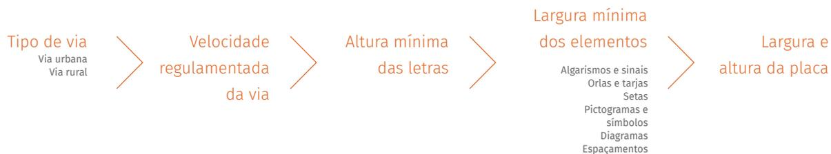
O procedimento não é definitivo, pois depende da locação da sinalização na via e dos ajustes necessários, quer pela falta de espaço para colocar determinada placa, quer pela própria configuração geométrica do local, que exige solução própria. Para que seja feita sua correta elaboração, deve-se atentar às determinações do item 7 (Diagramação das placas) do **Manual Brasileiro de Sinalização de Trânsito**, Volume III (Sinalização Vertical de Indicação).
