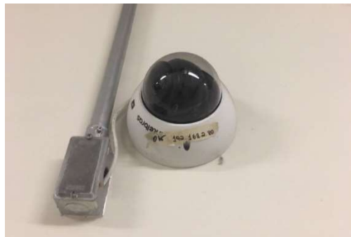
Figura 91 - Câmera de segurança interna em bom estado de funcionamento
